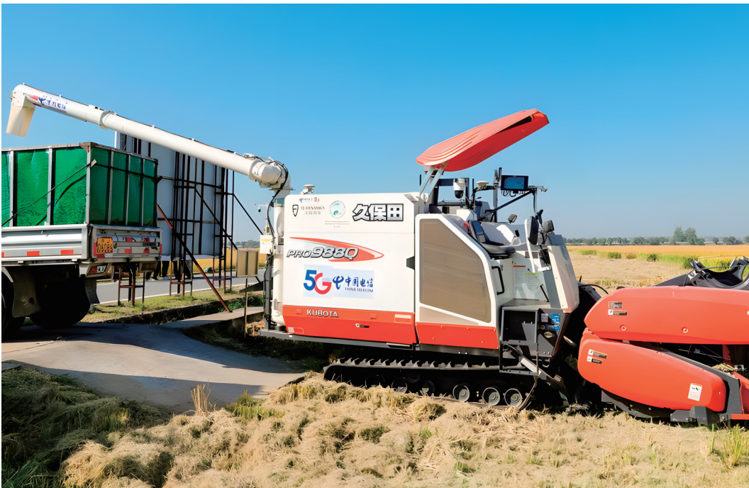
在江苏兴化智慧农业园，搭载着中国电信5G+北斗定位无人收割机在田间作业。
