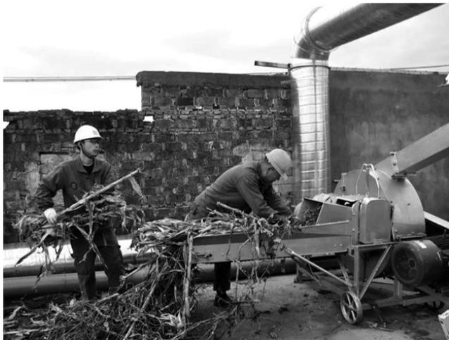
机肥原料了。这套设备一天可以处理8吨垃圾。同时，考虑到环保，我们还配备了除臭系统，保证在运行过程中没有污水产生，没有臭气散发。”
