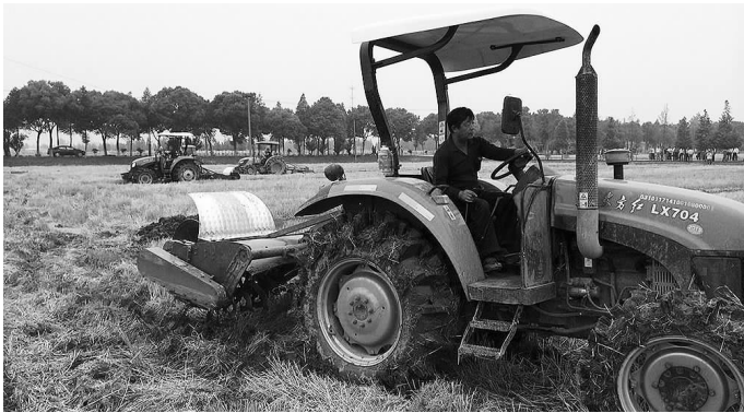
■新型田埂修筑机能够耕翻、筑埂同步进行,一次成型。
